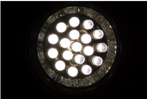
LED-Lampen – hier ein Spot – haben gegenüber der Energiesparlampe viele Vorteile. Vor allem enthalten sie kein giftiges Quecksilber. Foto Jörg Siebauer / pixelio.de
